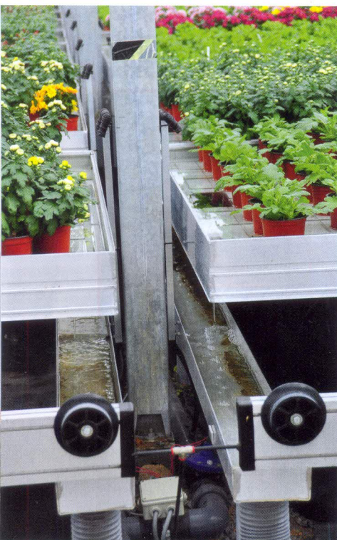
Speciální kohouty na zavlažování a postranní koryta pro odtok vody
